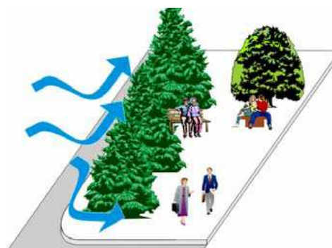
Σχήμα 2.10: Δέντρα με πυκνά φυλλάδια μπορούν να λειτουργήσουν ως ανεμοφράγματα το χειμώνα όταν τοποθετούνται στην πλευρά του επικρατούντος ανέμου. (πηγή: http://www.cres.gr/kape/education/design_guidelines_el.pdf )
