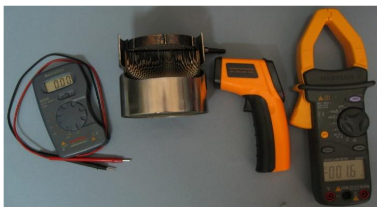
Εικόνα 3 Πολύμετρο, καταλύτης, θερμόμετρο υπεράυθρων και αμπεροτσιμπίδα συνεχούς ρεύματος.
