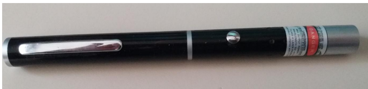
Εικόνα 7 Δείκτης laser πράσινου χρώματος που χρησιμοποιήθηκε στο πείραμα ( \lambda=532\text{nm} ).
