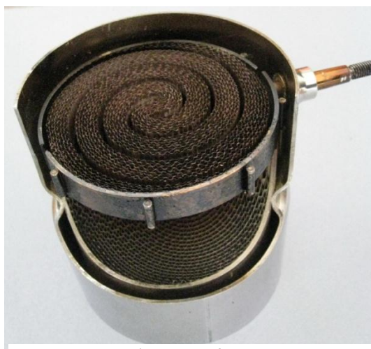
Εικόνα 1 Ηλεκτρικά θερμαινόμενος καταλυτικός μετατροπέας οχήματος.
