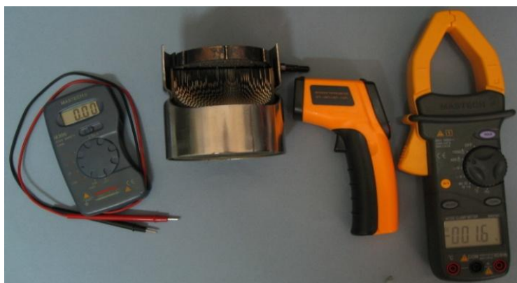
Εικόνα 3 Πολύμετρο, καταλύτης, θερμόμετρο υπερέθρων και αμπεροτσιμπίδα συνεχούς ρεύματος.
